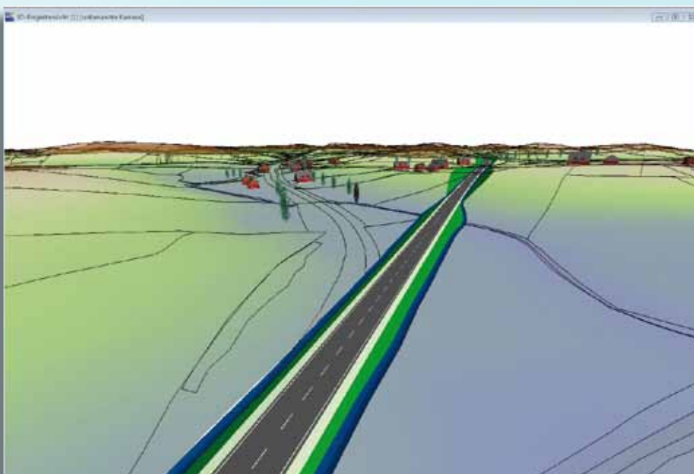
Bild 3: Das generierte Objekt Straße wird in der 3D Ansicht dargestellt. Die enge Bestandskurve weicht der gestreckten Linienführung.
