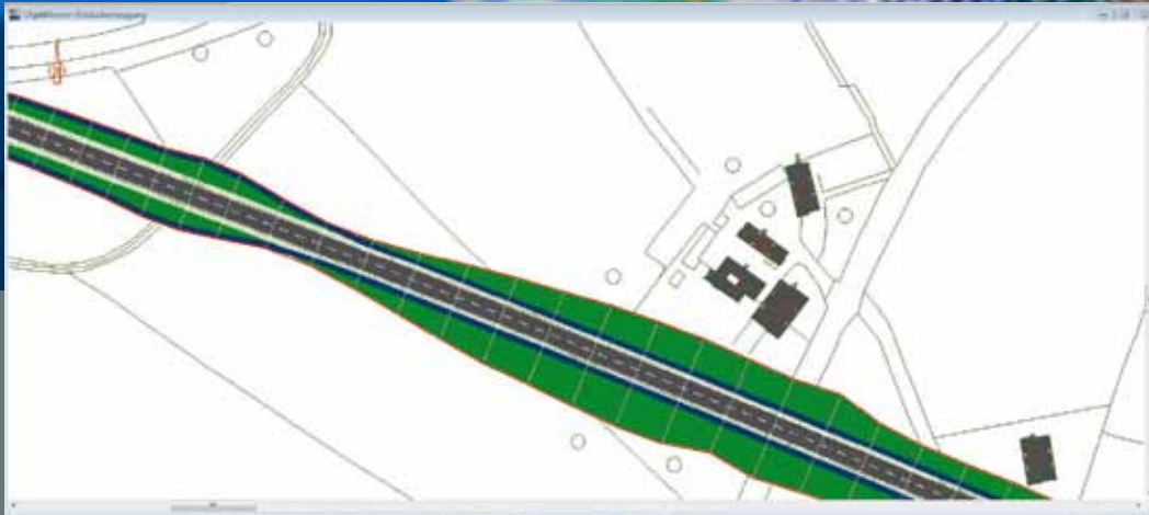
Bild 4: Lageplanansicht mit seitlichen Anschlusslösungen, inkl. der Böschungsbildung.
