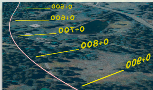
Bild 4: Entgegen der Stationierungsrichtung sind die Texte von hinten sichtbar.
