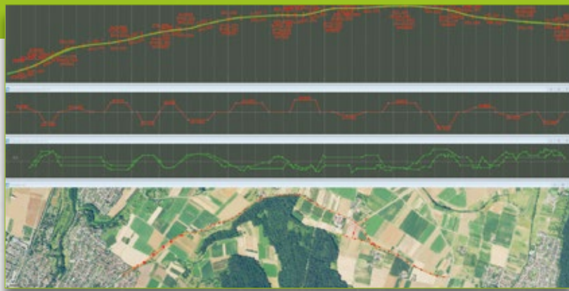
Bild 1: Im ersten Planungsschritt galt es, Längsschnitte, Krümmungsband und Querneigungen der Strecke zu betrachten.
