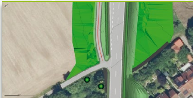
Bild 3: Ein Knotenpunkt schließt den Rad- und Wirtschaftsweg an die Straße an.
