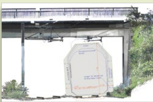
Bild 2: Visuelle Prüfung der Lichtraumprofilfreiheit durch Platzierung des EBO-Lichtraumprofils.
