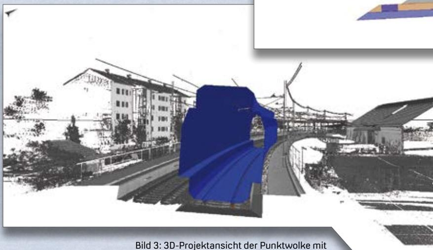
Bild 3: 3D-Projektansicht der Punktwolke mit daraus generiertem Oberbau und Lichtraum.
