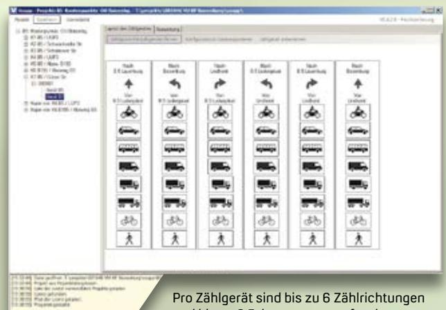
Pro Zählgerät sind bis zu 6 Zählrichtungen und bis zu 8 Fahrzeugarten erfassbar.
