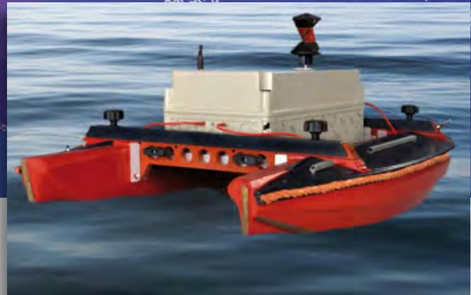
Bild 4: Ferngesteuertes Boot für Peilungsmessungen.
