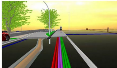
Bei dem Projekt mussten kreuzende Leitungen berücksichtigt werden. Bild: IB&T Software GmbH
