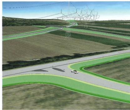
Bild 2 Einmündung mit einem Trassenkörper und 3D-Symbolen
