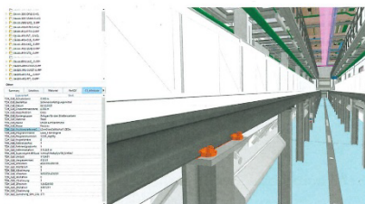
Koordinationsmodell der Betriebswerkstatt mit Auszug aus den Attributen der Schienenbefestigung.
