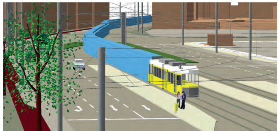
Mit dem neuen Hüllkurvenmodul lässt sich der Platzbedarf von Schienenfahrzeugen auf sämtlichen Gleisstrassen berechnen.
