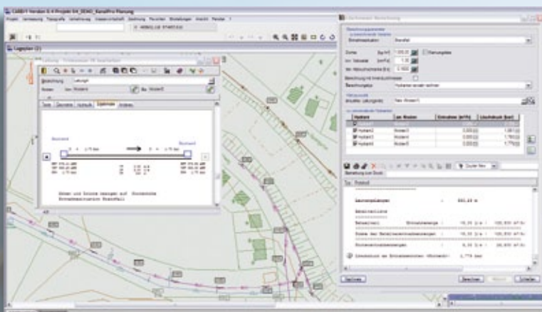
Löschwasserberechnung mit Nachweis der Feuerlöschhydranten.
