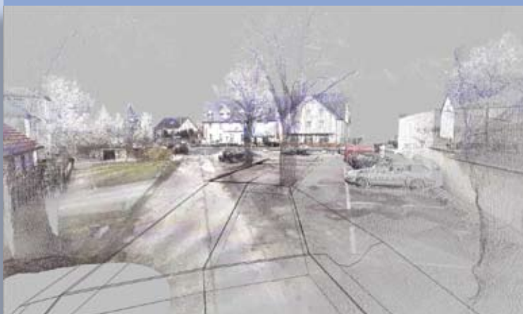
3D-Scannerdaten sind im Kommen: Kombinierte Darstellung von Punktwolken und Querprofilen.
