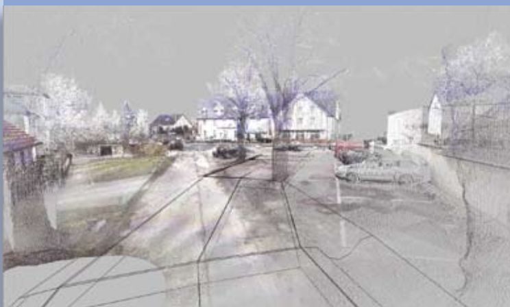
Datele scanate 3D sunt de viitor: prezentare combinată de ploaie de puncte și profile transversale.
