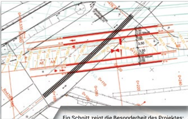
Ein Schnitt zeigt die Besonderheit des Projektes: Die neu geplante Straße kreuzt ein Industriegleis.
